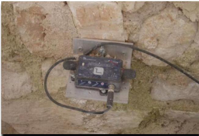
Inclinometro misura variazioni del centesimo di grado
